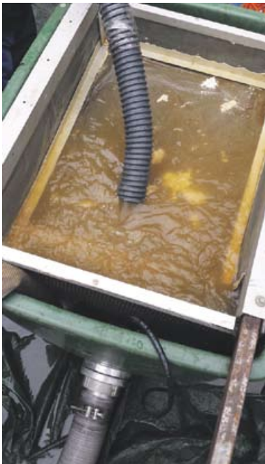
Austragskontrolle im 63µ Sieb: Deutlich sind die ausgefällten Eisenoxide als rostbraunes Verockerungssediment erkennbar – es gehört nicht ins Brunnenwasser.
